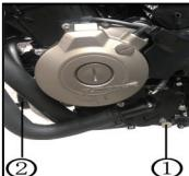
(1) Al drenar el aceite, coloque una bandeja de drenaje debajo del puerto de drenaje de aceite, retire el tornillo de drenaje ①, después de vaciar completamente el aceite del cárter, reinstale el tornillo de drenaje con un torque de 20~25N.m y cambie el filtro de aceite ② siguiendo estos pasos:
