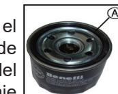
①. Utilice una herramienta especial para desmontar el filtro de aceite, atrape el filtro y gírelo en sentido antihorario para quitarlo.
