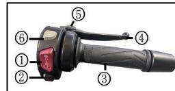
Cuando estén en la posición "⊗" no puede arrancar, el circuito se corta y el motor.
