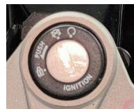
"○" El símbolo .....en la llave indica la posición "○" donde se conecta la alimentación, el motor puede arrancar y la llave no se puede extraer;
