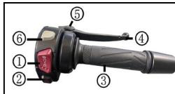
Quando l'interruttore è premuto sulla posizione "**○**", il circuito elettrico del veicolo è collegato e il motore può essere avviato.
