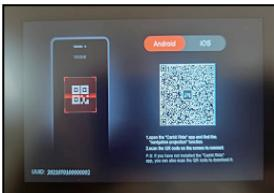
accedere all'interfaccia di proiezione wireless. Selezionare il codice QR del sistema Android o Apple premendo brevemente il pulsante "SELECT" (prima della connessione, è necessario verificare se il numero UUID è attivato; se non attivato, verranno fornite istruzioni correlate; gli UUID non sono condivisi tra l'interno e l'estero). Come mostrato nell'immagine:
