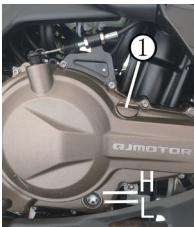
Cuando el nivel de aceite esté por debajo de la marca L en la parte inferior, abra la tapa del puerto de llenado de aceite ① en la parte superior y agregue aceite hasta la marca superior H.
