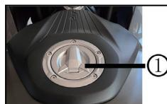
tanque de combustible con su guía y presione hacia abajo para cerrarla hasta que escuche un clic, luego retire la llave y cierre la tapa a prueba de polvo.
