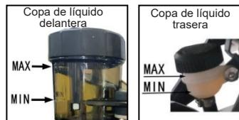
la marca de límite inferior MIN, agregue el líquido de frenos especificado según sea necesario. El depósito de líquido de frenos trasero está instalado en la parte central derecha del vehículo, y el nivel del líquido debe mantenerse entre las marcas MIN (o LOWER) y MAX (o UPPER). Si el nivel está por debajo de la línea MIN (o LOWER), se debe agregar el líquido de frenos especificado. El llenado del líquido de frenos debe considerarse una parte esencial del mantenimiento periódico.
