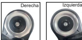
la y en sentido antihorario (dirección S) para disminuir la fuerza de amortiguación. Asegúrese de ajustar ambas amortiguadoras al mismo nivel de resistencia.
