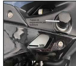
Nei veicoli nuovi, il liquido refrigerante è già installato. Durante la manutenzione, prestare attenzione al controllo dell'altezza del liquido refrigerante nel serbatoio di espansione.
