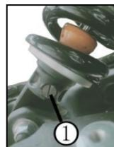
Girando la tuerca de ajuste ① en la parte inferior del amortiguador, se puede ajustar la fuerza de amortiguación: use un destornillador plano para girar la tuerca de ajuste en sentido horario o antihorario,
